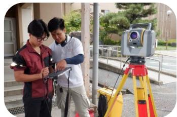
今年度も株式会社大翔様より測量技術者をお招きして、本校体育館を地山に見立てた3次元点群データ取得の講習会を実施いたしました。オルソ画像に変換していただき、コンピューター画面上で各自、任意の点間距離を調べることができました。地上型レーザースキャナーとUAV写真測量、UAVレーザー測量で座標や色相をデータ化したので、視覚的に分かりやすくなり理解が深まりました。
